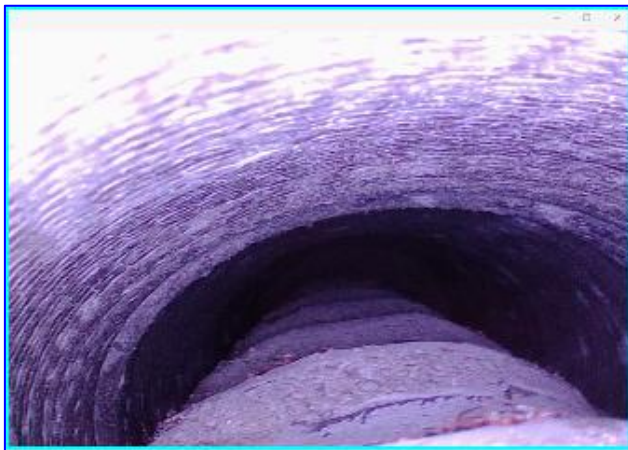
图 7.3.1-1 内窥镜检测套筒内部不饱满成像示意图
