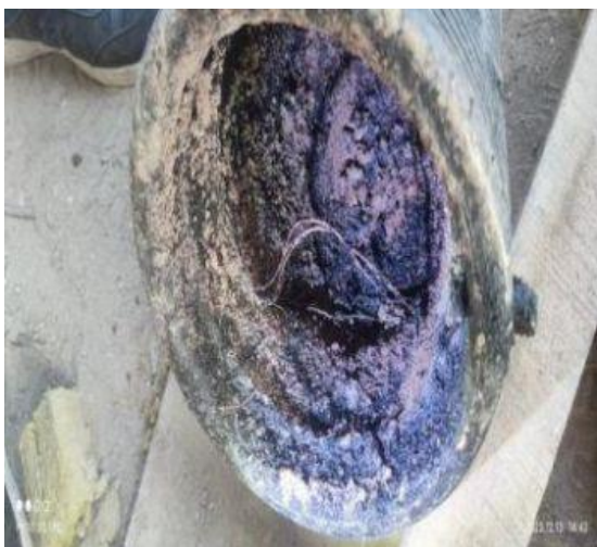
图 11.4.1.3 电热熔或热熔管件连接不规范
