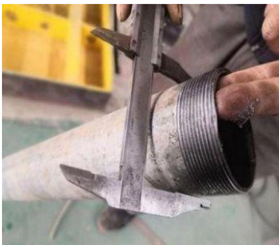
图 11.4.1.1 管道螺纹烂牙、断丝、丝牙长度不足
