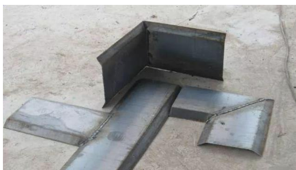
图 10.2.3-3 转角止水钢板加工成品示意图
