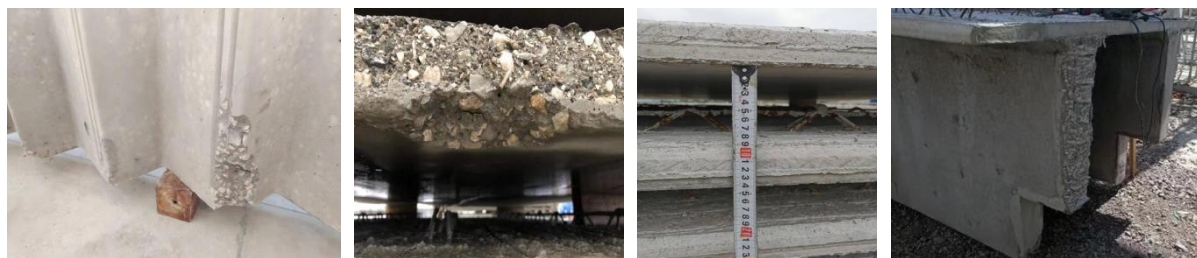
图 7.1.1-2 构件缺棱掉角、尺寸偏差
