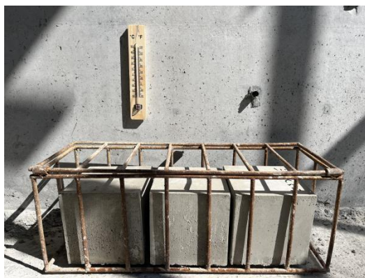
图 14.5.3-1 同条件试块养护现场图
