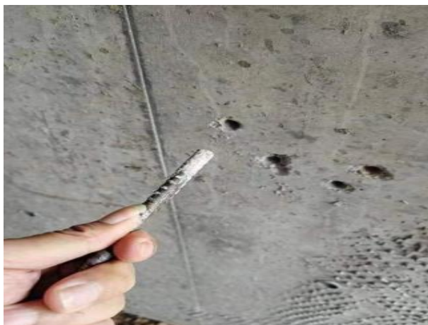
图 5.11.1 植钢筋不满足抗拉拔实验要求
